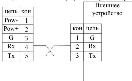
Рисунок Б.1 Схема подключения внешнего устройства через адаптер интерфейса RS-232
